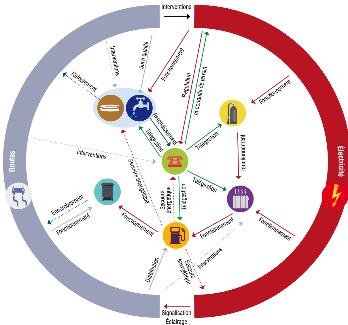
Schéma des interdépendances entre réseaux. D'après le Guide Orsec Retap'Réseaux. En pointillés, les interactions spécifiques aux situations d'inondation.
